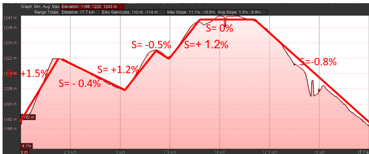
شکل ۱۰۷-۴: شیب طولی مسیر گزینه ۲۲ از ایستگاه شهر ملکی تا آزادی
