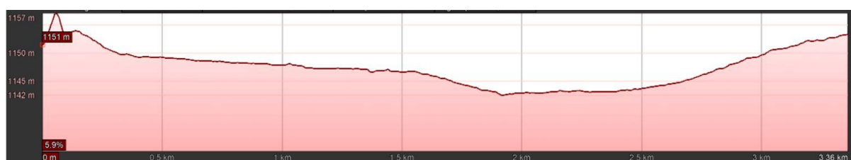
شکل ۱۰۸-۲: پروفیل طولی قطعه ۲ جاده شهریار
